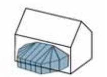
A più falde raccordate a 135°
