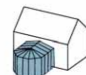
A padiglione con raccordi a 135°
