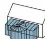
A padiglione con raccordi a 135° ou 150°
